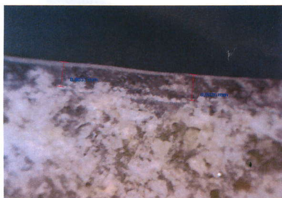
Měření tloušťky podlahoviny, stanovena 0,90 mm
